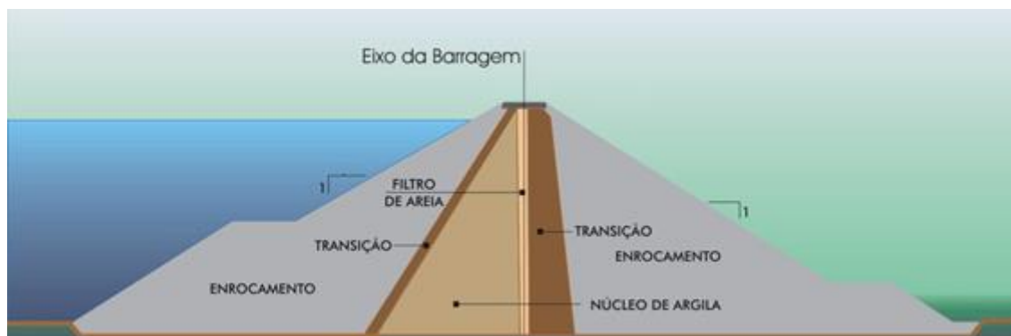
Figura 10. Corte típico de barragens de hidrelétricas
